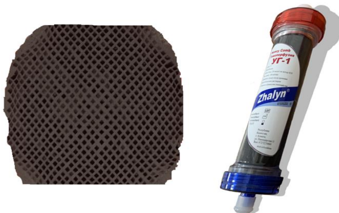
29 – сурет. Дайын өнім – көпарналы құрылымды көміртекті-кремнийлі гемосорбент
