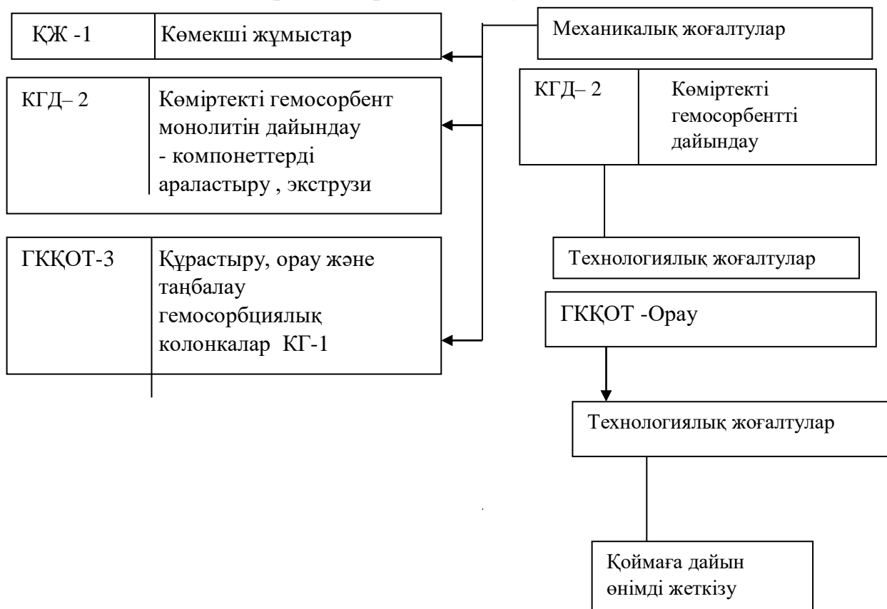
25 сурет-гемосорбент алудың принципіалды схемасы
