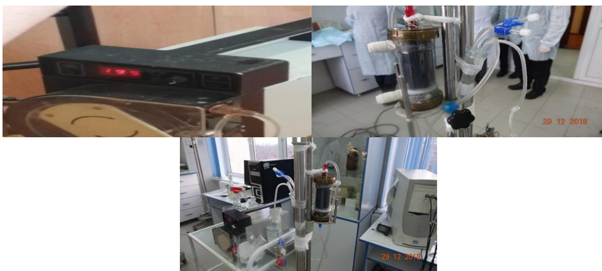
32-сурет.Ресейлік ролик сорғысында гемосорбентті тұзды ерітіндімен жуу
