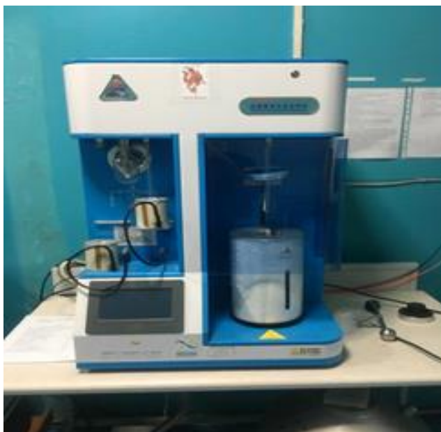
14–Сурет. Меншікті бетті өлшеуге арналған сорбтометр000
